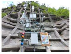
そしてこちら(写真下)は、雨量・熱中症指数・風速・落石感知が一箇所に集約された装置。危険な数値に達すると、それぞれ色分けされたライトが光り一目でわかります。上部には Wi-Fi アンテナも設置。衛星を介して Wi-Fi エリアを作ることで、山奥の現場でも LINE アプリを使っての情報共有や遠隔臨場を可能にするなど、DX 促進にも一役買っています。
